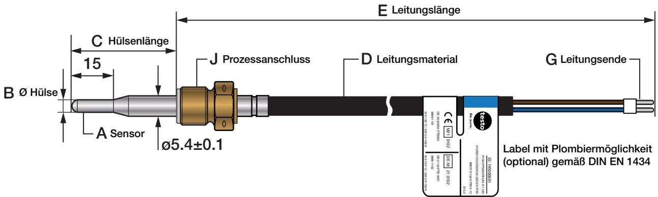
**Montage Temperaturfühler für den Direkteinbau**
