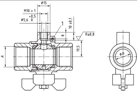
Der Einbau von Temperaturfühlern in Rohrleitungen ( $q_p \leq 6$ ) muss in Deutschland in Neuanlagen direkt erfolgen. Der direkte Einbau der Temperaturfühler ist gemäß DIN EN 1434-2 und der Technischen Richtlinie TR-K8 auszuführen (siehe nachfolgende Abbildung).
